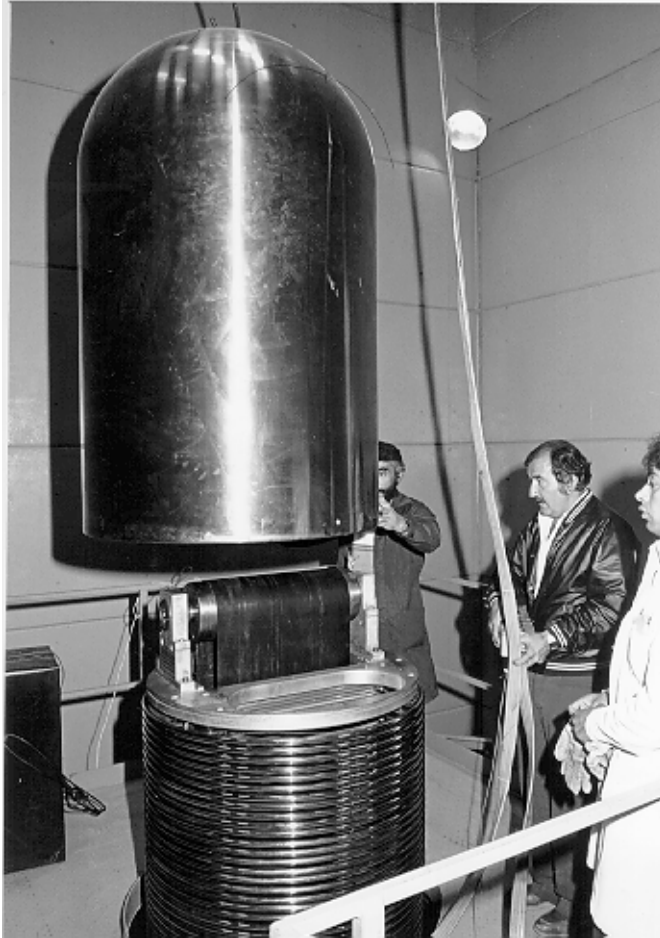
Figura 9. Domo metálico y sección de columna del acelerador VDG de 5.5 MV
